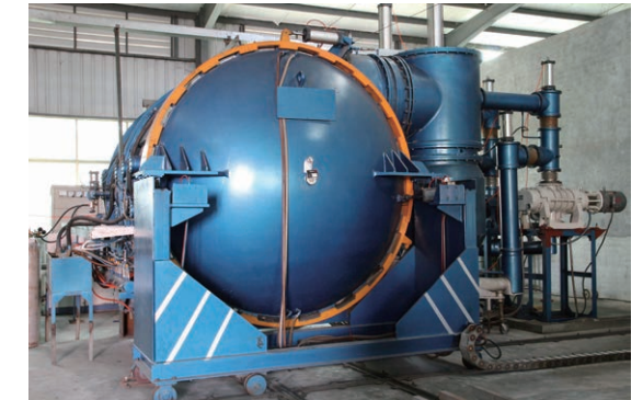
钨钢粉末高温烧结炉 Tungsten powder sintering furnace
